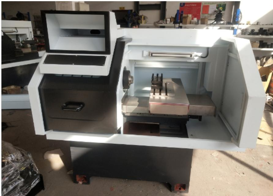
一般来说，数控光机诊断功能提示的故障信息越丰富，越能给故障诊断带来方便。但要注意的是，有些故障根据故障内容提示和查阅手册可直接确认故障原因；而有些故障的真正原因与故障内容提示不相符，或一个故障显示有多个故障原因，这就要求维修人员必须找出它们之间的内在联系，间接地确认故障原因。CNC系统的自诊断不但能在CRT显示器上显示故障报警信息，而且能以多页的“诊断地址”和“诊断数据”的形式提供机床参数和状态信息，常见的数据和状态检查有参数检查和接口检查两种。参数检查数控光机的机床数据是经过一系列试验和调整而获得的重要参数，是机床正常运行的保证。这些数据包括增益、加速度、轮廓监控允差、反向间隙补偿值和丝杠螺距补偿值等。新疆斜床身数控光机数控光机的伺服系统可以用于实现数控光机的进给伺服控制和主轴伺服控制。
